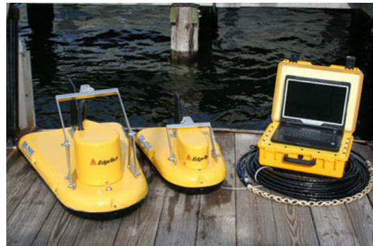
Fig. 3 – Hardware e Towfish 4-24 (trasduttore) SBP
